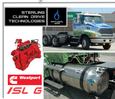
Factory Installed LNG Fuel Tanks
